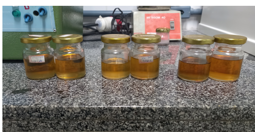
Figura 11 – Inspeção visual de sedimentação.
