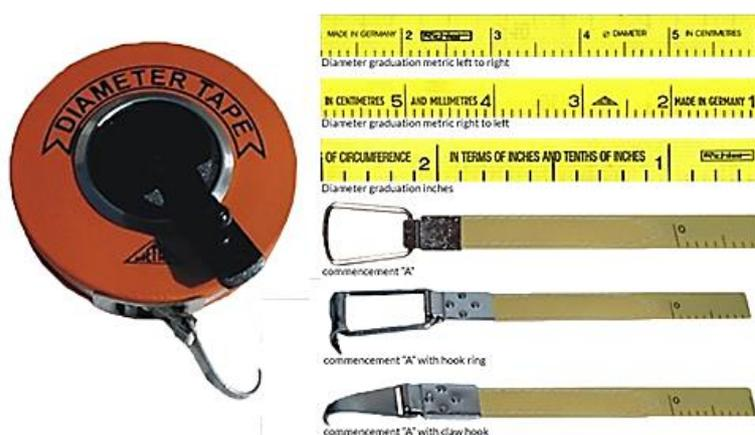
Figura 6 – Fita diamétrica. Fonte: TerraGes, 2021.
