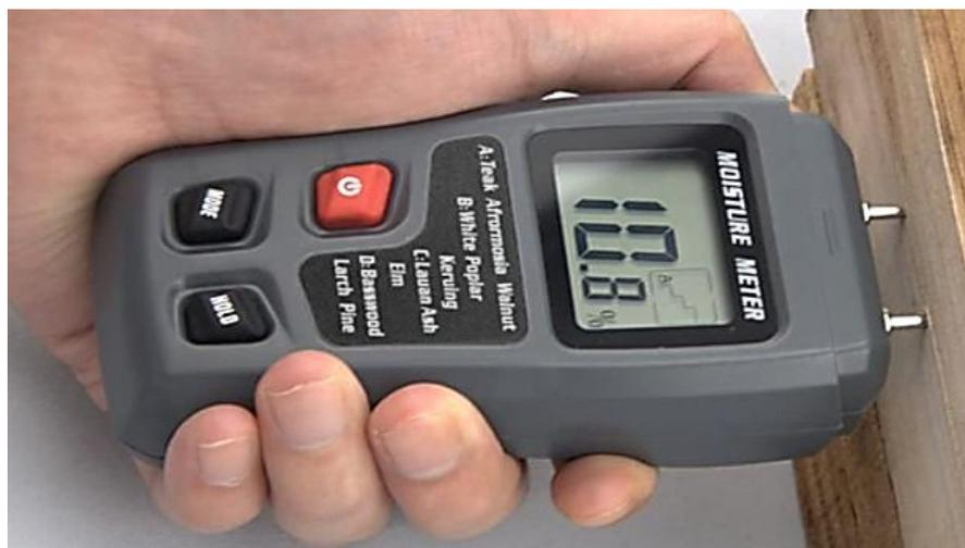
Figura 41 – Medidor de umidade para madeira verde. Fonte: amazon.com (2021).
