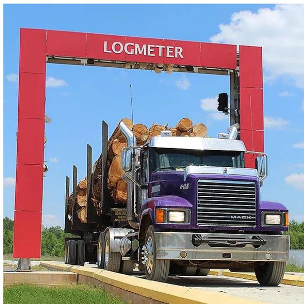
Figura 42 - Escâner que mede cargas de madeira com feixe de laser. Fonte: Woodtech (2021).
