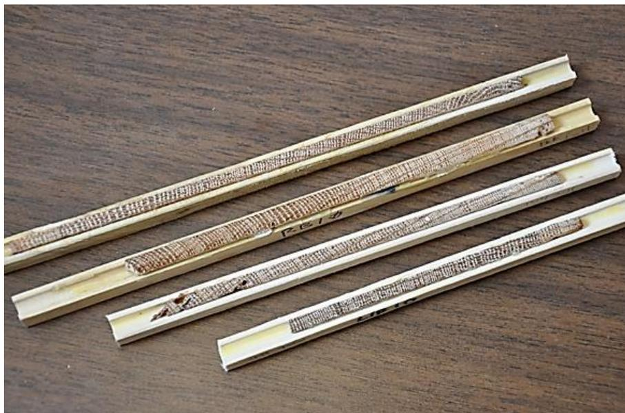
Figura 47 – Cilindros de amostra de tronco obtidos com trado de incremento e colados em base de madeira para proteção. Fonte: Theisen (2011).
