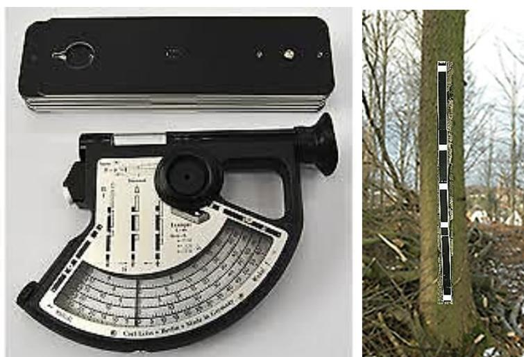
Figura 19 - Hipsômetro Blume-Leiss com telêmetro.
