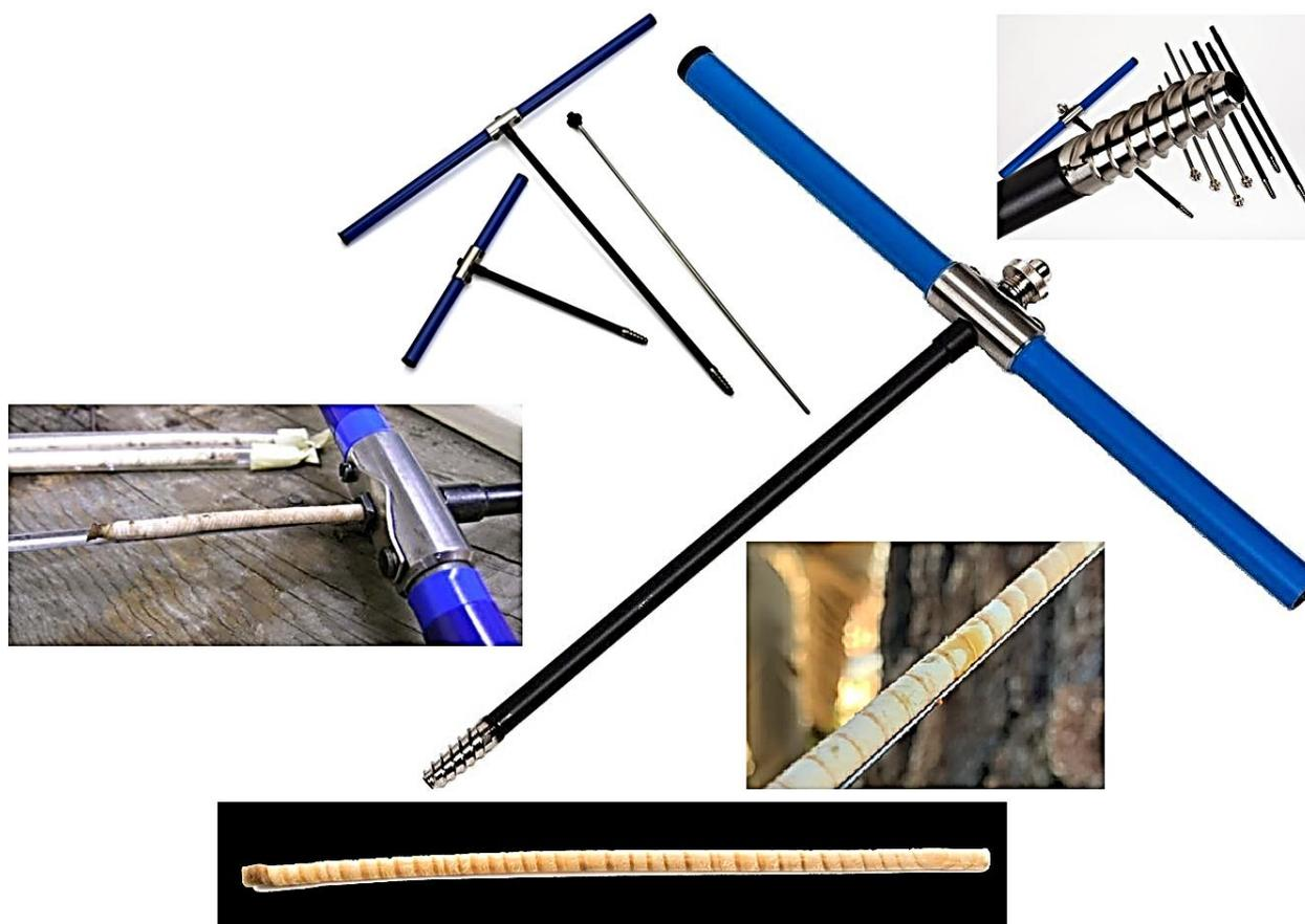
Figura 46 – Amostragem para análise parcial de tronco com trado de incremento.
