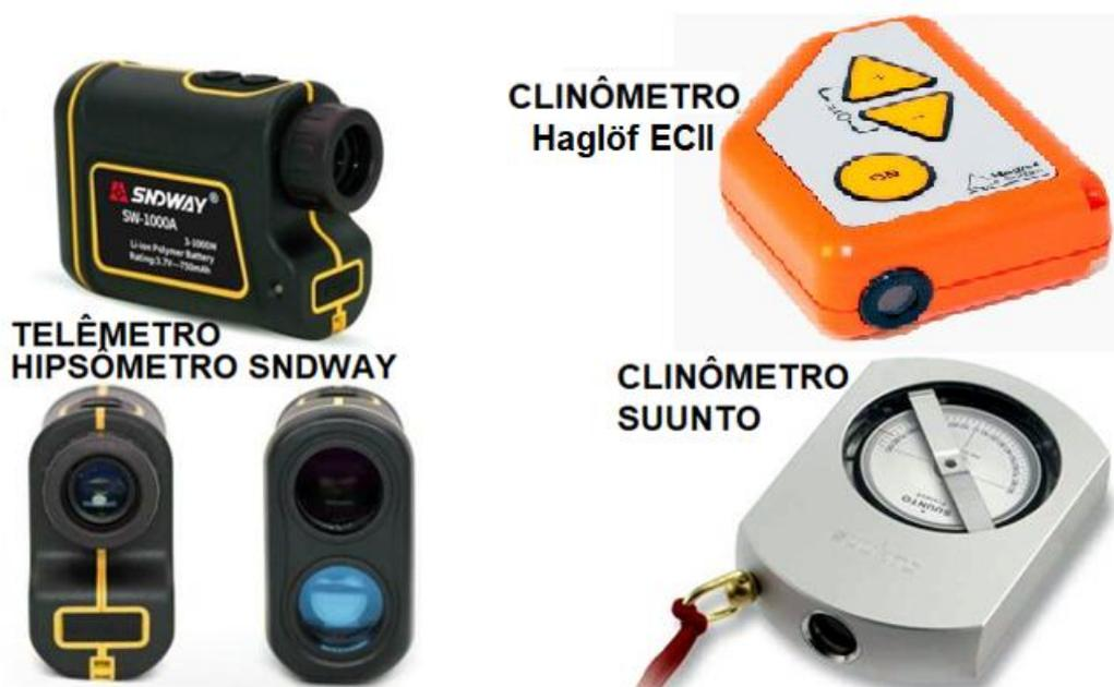
Figura 15 – Telêmetro hipsômetro SNDWAY SW-1000A, clinômetro Haglöf ECII e clinômetro Suunto.
