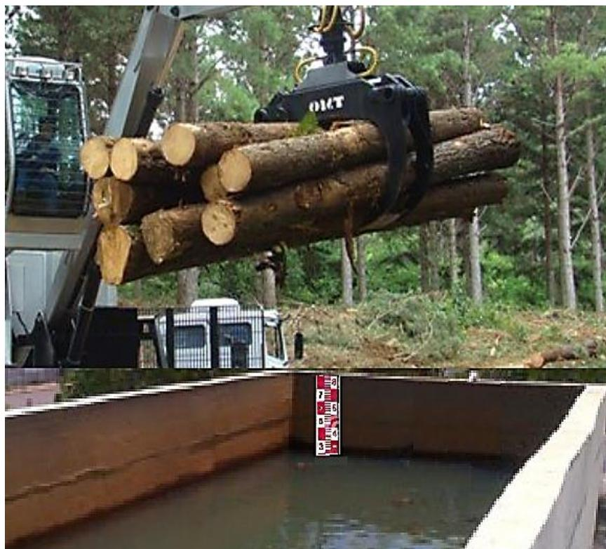
Figura 38 – Medição de volume de madeira pelo método do xilômetro.
