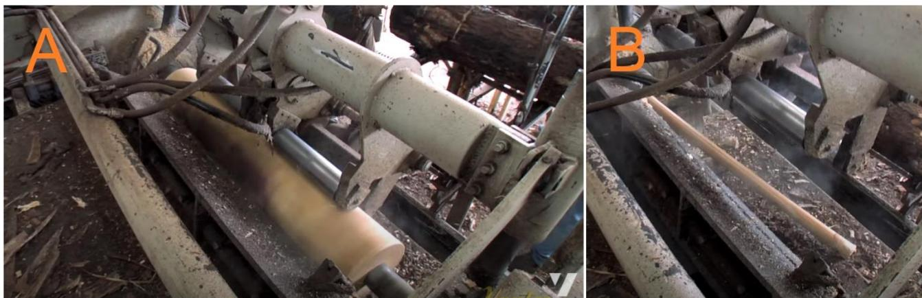
Figura 34 – A) Tora sendo laminada em torno; B) Cilindro remanescente após laminação. Fonte: Vantec (2021).
