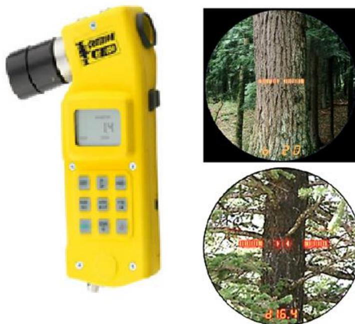
Figura 59 – Dendrômetro Criterion.
