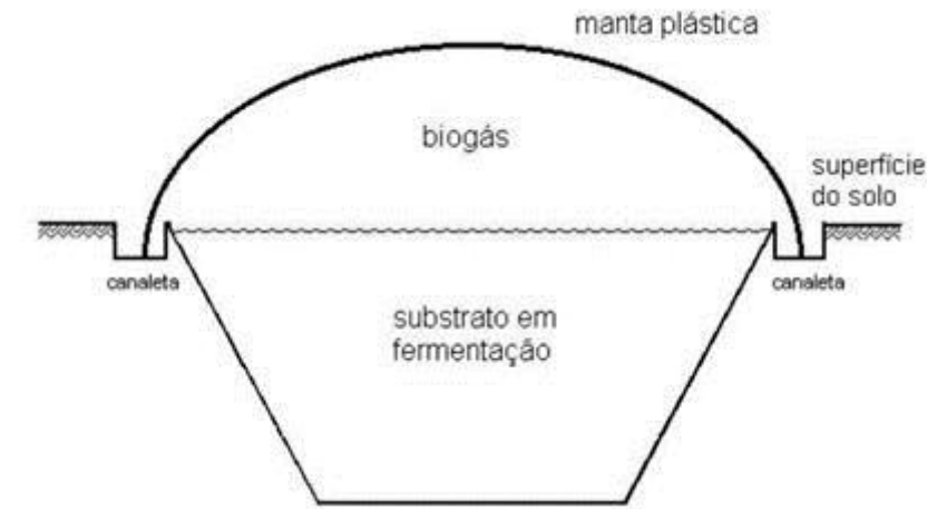
Figura 28: Biodigestor Batelada Tubular com manta plástica (seção transversal)
