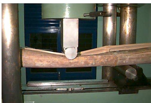
**Ilustração 30: Ensaio de flexão realizado por Rubens Cardoso.**
