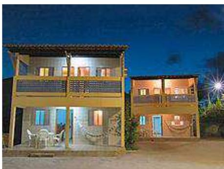
**Ilustração 61: Fachada de residência em Barra de São Miguel – observa-se os elementos de proteção solar: grandes beirais, varandas e elementos vazados.**
