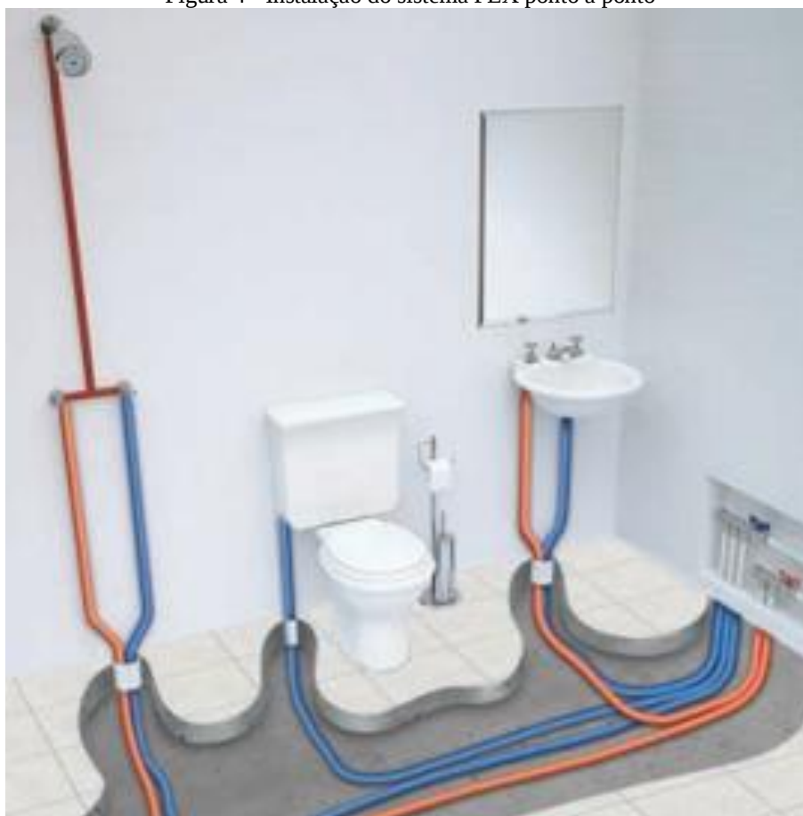
Figura 4 - Instalação do sistema PEX ponto a ponto
