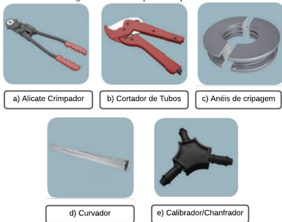
Figura 6 - Ferramentas para instalação do PEX
