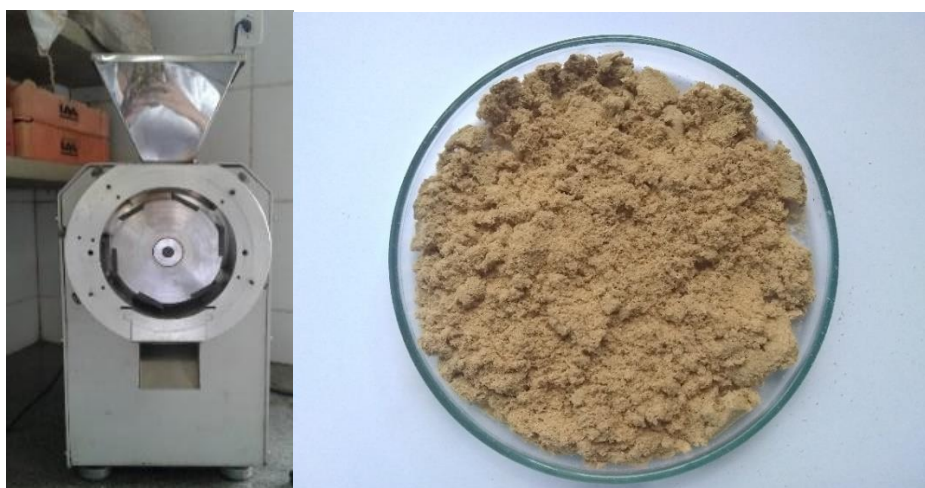
Figura 10 - Moinho de facas utilizado para pulverização do colmo desidratado G. angustifolia (A); Pó obtido do colmo desidratado da G. angustifolia (B)
