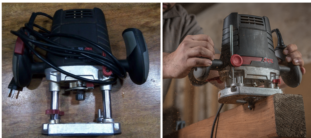
Figura 63 e 64 - Tupia Manual e processo de acabamento de quinas.
