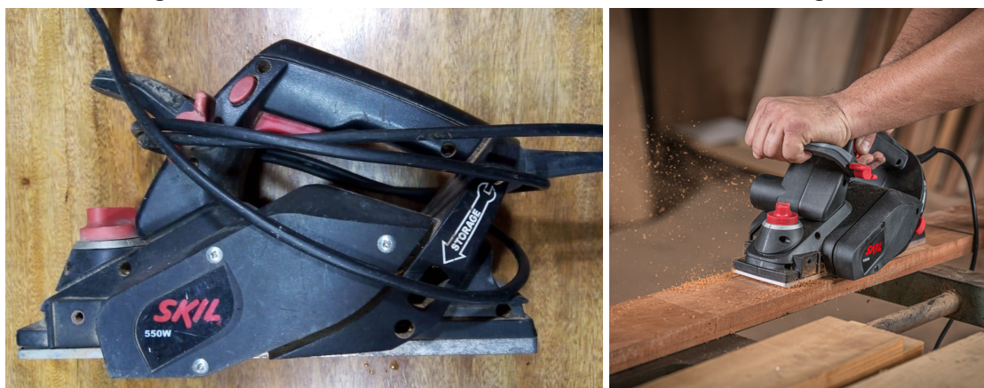
Figura 59 e 60- Plaina Elétrica existente e Processo de Planagem.
