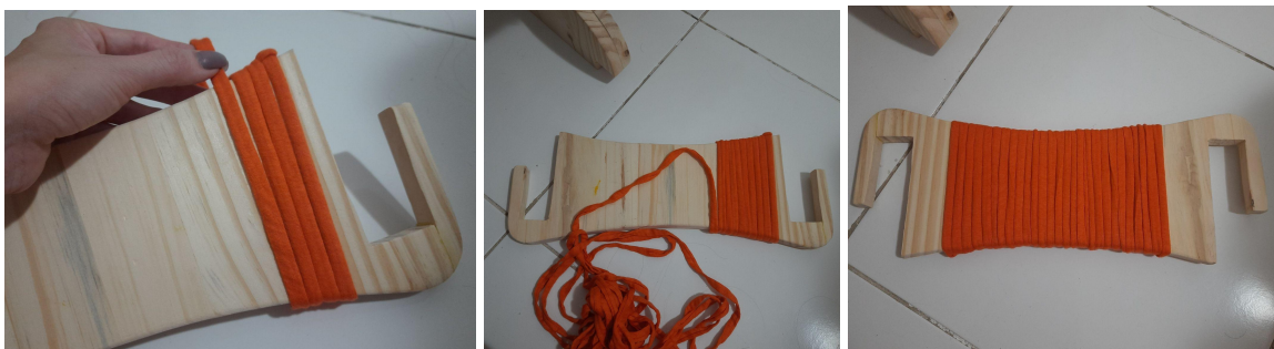
Figuras 99,100 e 101 - Revestimento do apoio para os pés.
