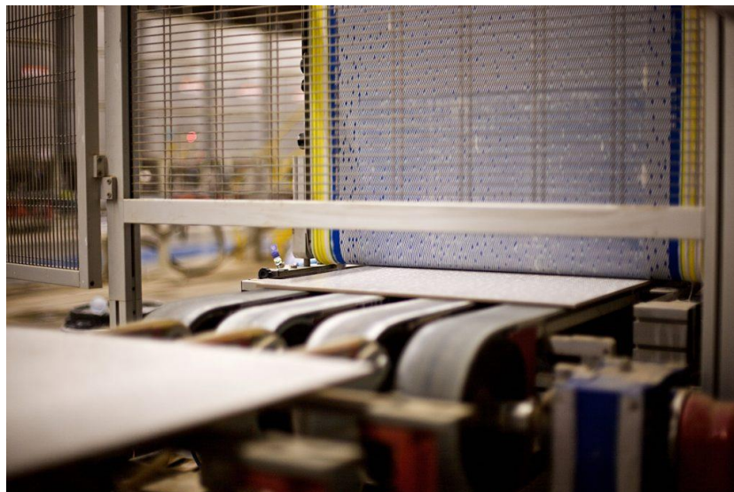
Figura 33 - Impressora dá o acabamento final antes da queima
