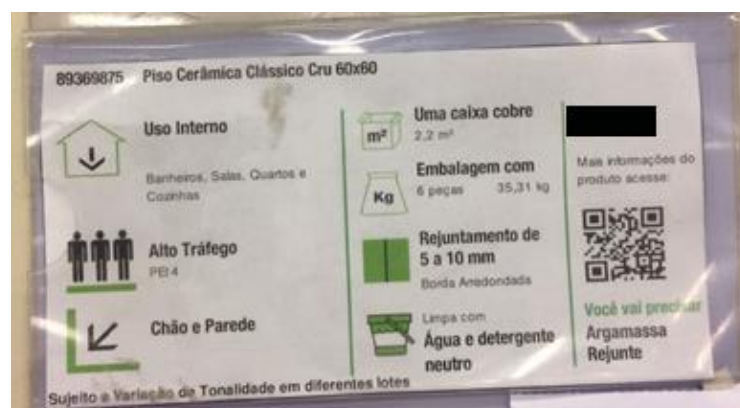
Figura 35 - Informativo exposto nas placas de aplicação em piso
