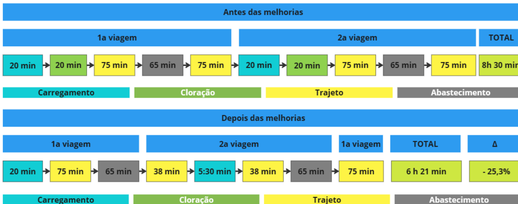
Figura 23 - Comparação entre os ciclos de abastecimento antes e depois das melhorias na zona Roxa.
