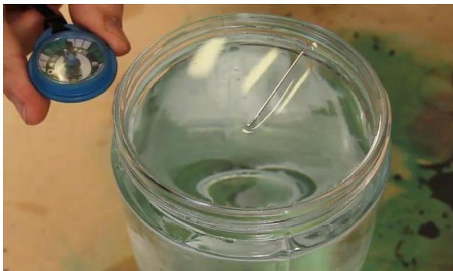
**Figura 13** – Bússola feita com agulha magnetizada e recipiente com água
