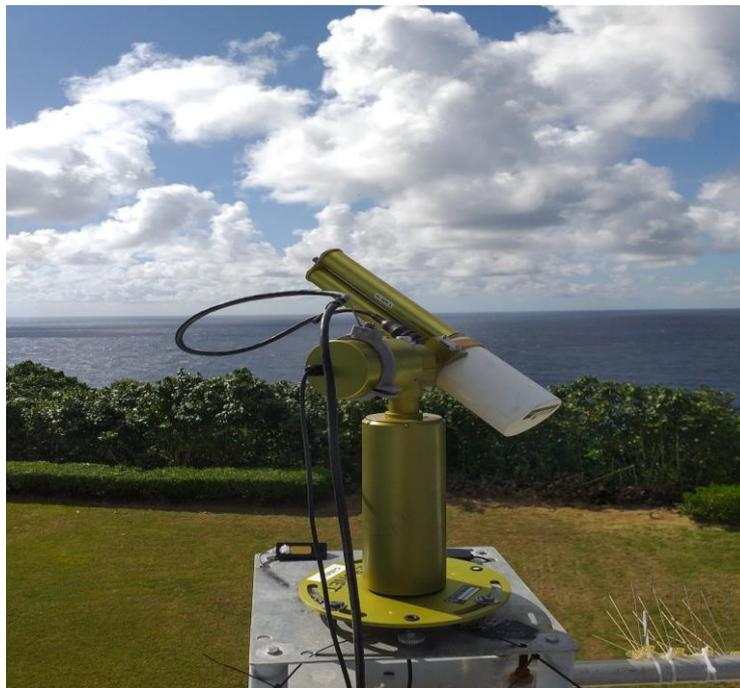
**Figura 8-** Fotômetro solar CIMEL CE318 localizado na França. Fonte: AERONET.
