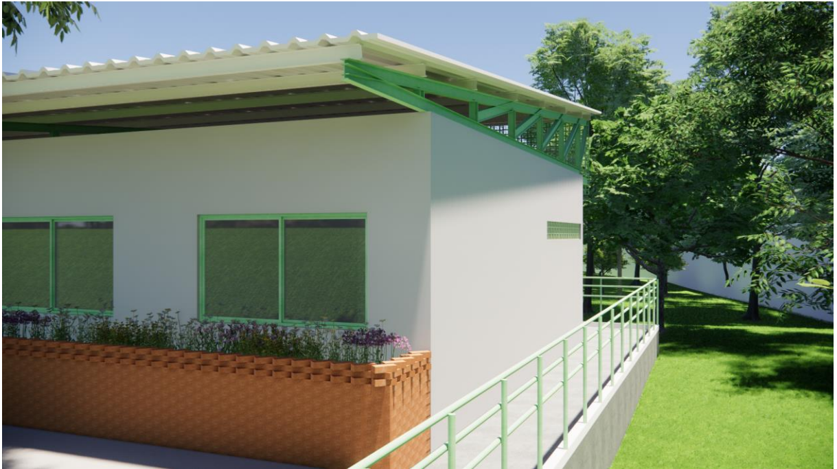
Figura 39: Beiral mais curto na face oeste do corredor das salas de atendimento. Fonte: Elaboração autoral, 2023.
