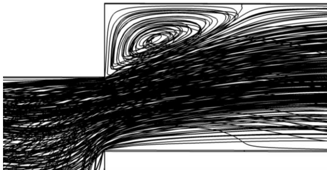
Figura 2.10 - Linhas de fluxo formando um vórtice de expansão após aumento abrupto da área da seção transversal. Fonte: autor.
