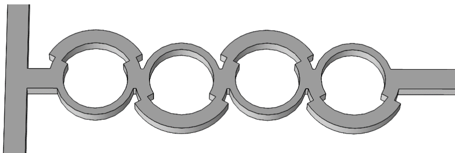
Figura 1.12 - Esquema 3D de modelo desenvolvido por Li com micromixer planar de divisão e recombinação redondo com colisões desequilibradas e subcanais deslocados. Fonte: Autor.
