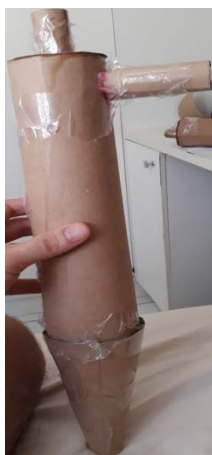
Figura 13: Protótipo hidrociclone "Rietema"
