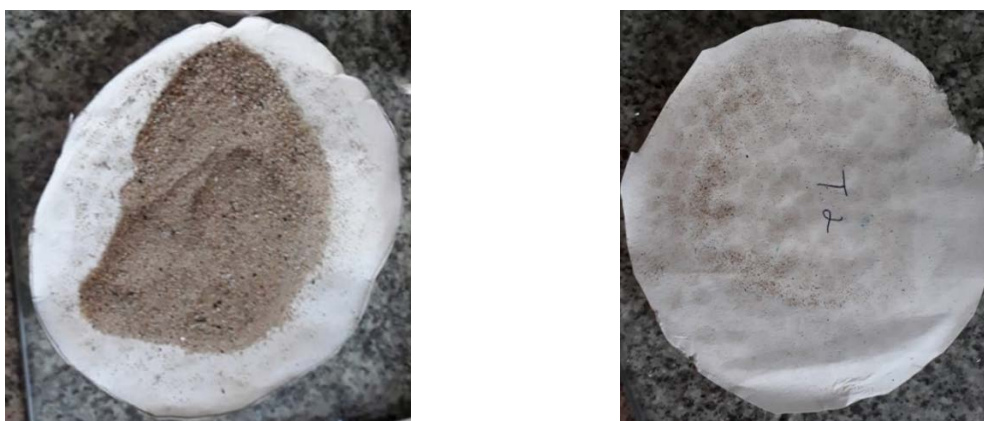
Figura 25: Amostras do Underflow e do overflow
