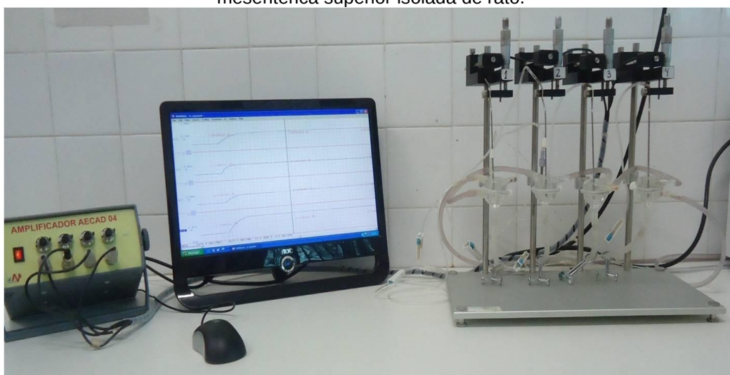
Figura 17 – Aparato utilizado para registros de tensões isométricas em anéis de artéria mesentérica superior isolada de rato.
