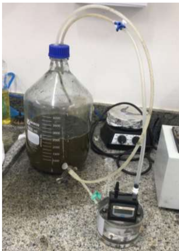
Figura 6 - Biodigestor em operação.
