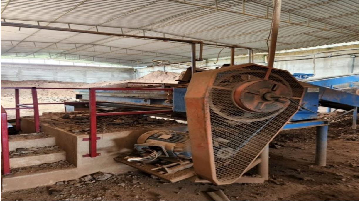
Figura 6 - Laminador de Argila da Cerâmica Alagoas.
