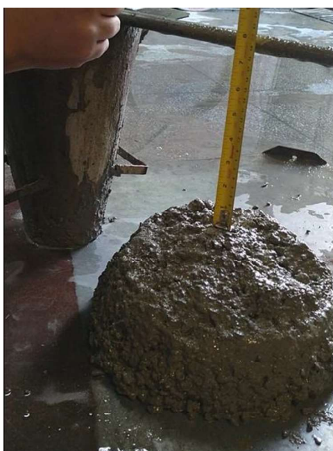
Figura 25 - Ensaio de abatimento do tronco de cone ( slump test )
