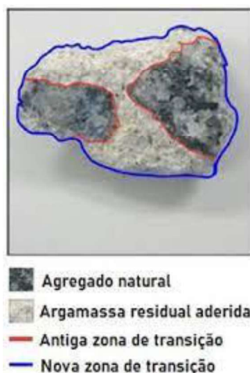
Figura 10 - Delimitação da zona de transição formada no agregado reciclado
