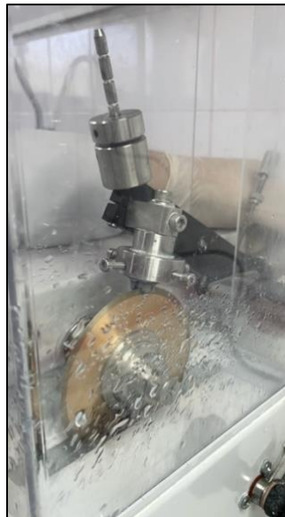
Figura 8 - Amostra sendo cortada na cortadeira de precisão (Labcut 1010).
