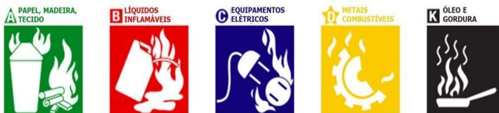
Figura 1 – Classes de extintores de incêndio
