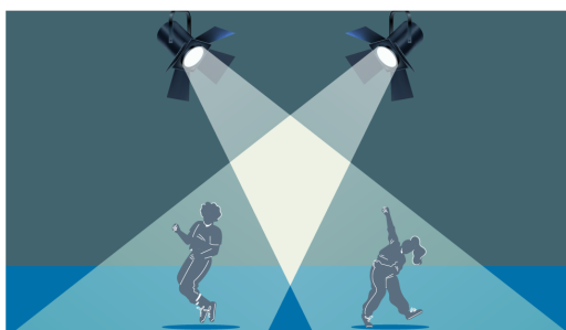
Figura 20 - Representação gráfica do princípio da independência dos raios luminosos, onde duas fontes luminosas se cruzam sem que uma altere a propagação da outra.
