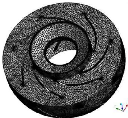
Figura 1 – Malha do modelo de um impelidor
