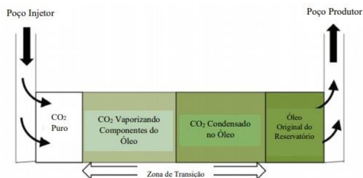
Figura 14 – Processo de miscibilidade por múltiplos contatos entre CO 2 e o óleo no reservatório.
