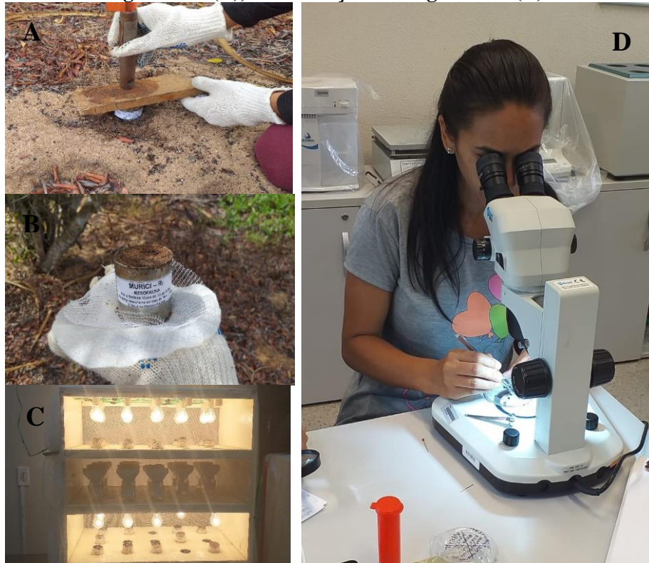
Figura 12 - Instalação de anéis metálicos para coleta de amostras de solo (A), Amostras de solo (B), Instalação dos anéis metálicos na bateria de extratores Berlese-Tullgren para extração dos organismos (C), Identificação dos organismos (D).
