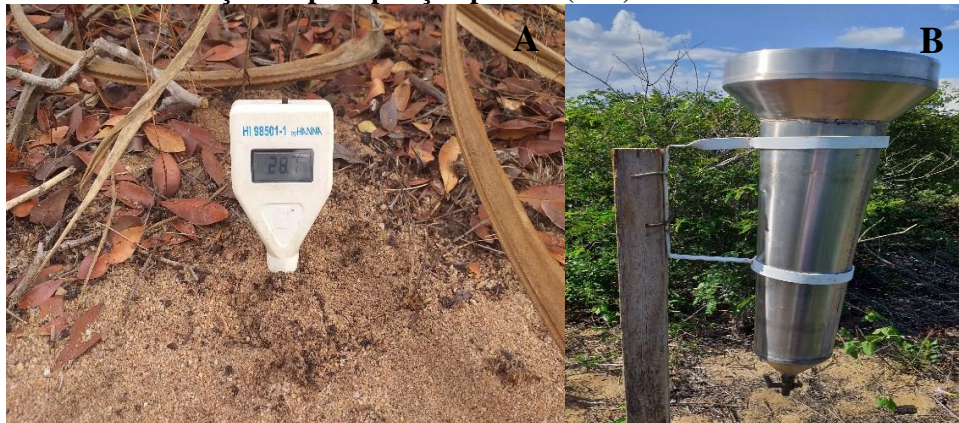
Figura 14 - Termômetro digital modelo espeto para medição da temperatura do solo (°C) (A) e pluviômetro Ville de Paris (B) utilizado para medição da precipitação pluvial (mm).
