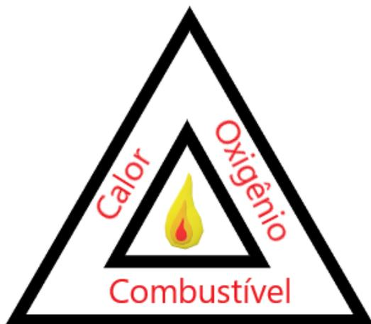
**Figura 1.** Representação do Triângulo do Fogo: combustível (folha, ramo, material em decomposição, etc.), oxigênio (comburente) e calor (necessário para iniciar a reação entre os demais fatores). A ausência de qualquer fator resulta no decaimento/extinção do fogo.
