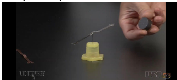
Figura A.2. Colocação da haste de ferro sobre a agulha na base isolante. Fonte: https://www.youtube.com/watch?v=47hDMWh89RE
