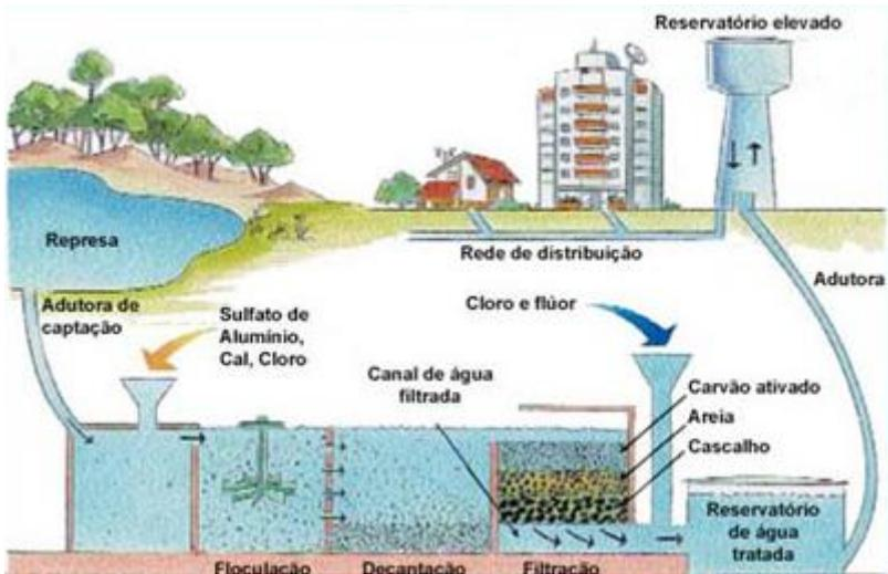
**Figura 5.** Modelo de sistema de abastecimento e distribuição de água.
