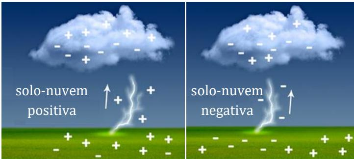
**Figura 5.** Esquema ilustrativo de descargas elétricas atmosféricas do tipo solo-nuvem (a) positivas e (b) negativas.
