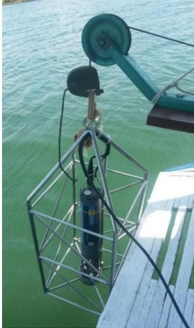
**Figura 8.** Sonda Multiparamétrica para amostragem da salinidade e temperatura.
