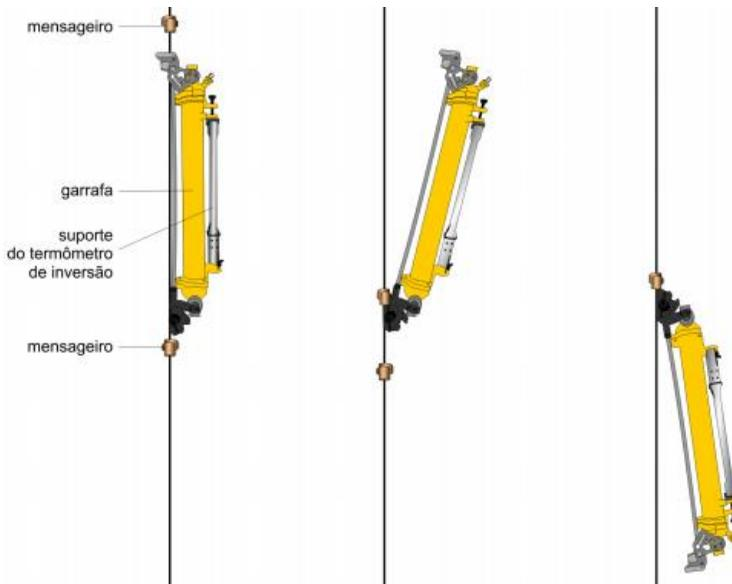
**Figura 2.** Esquema de fechamento de uma garrafa Nansen. Um mensagemeiro desde e dispara o mecanismo superior, que se abre liberando a garrafa do cabo; fixada pela base, ela gira; garrafa invertida.
