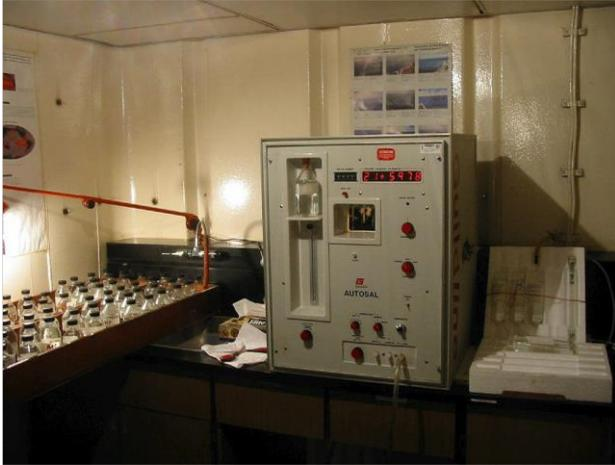
**Figura 5.** Salinômetro de alta precisão AUTOSAL.
