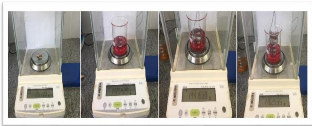
Figura 8- Passo a passo da metodologia utilizada nos testes: (a) Pesagem da amostra, (b) Medição do volume do líquido, (c) Contato entre a amostra e o líquido, (c) Gotejamento
