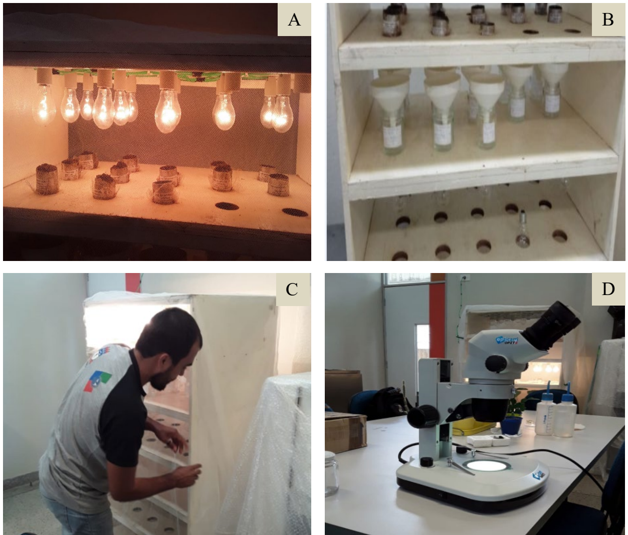
Figura 7 - Parte superior da bateria de extrator Berlese-Tullgren modificada (A), parte inferior onde foram instalados os frascos de vidro contendo álcool 70% e funis (B), equipamento coberto com tecido tule (C), identificação e contagem dos indivíduos da mesofauna edáfica (D).
