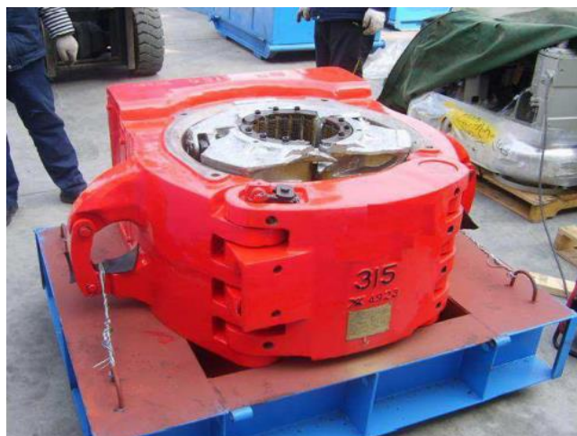
Figura 5 - Aranha ou spider usado para sustentar o revestimento
