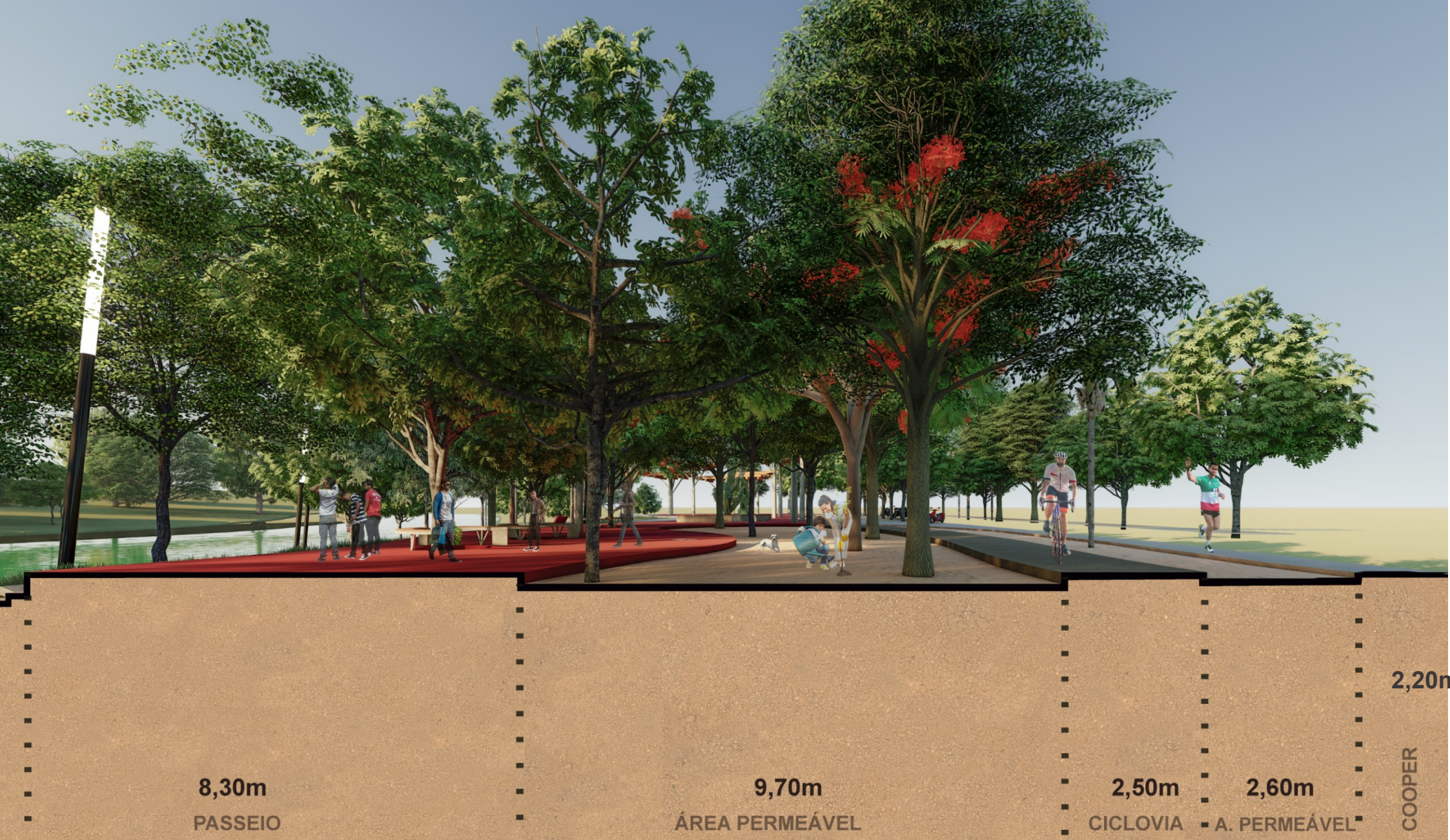
Figura 55: Corte GH, na área seca da zana Alpandre, com destaque para os pisos, área permeável e ampla cobertura vegetal.
