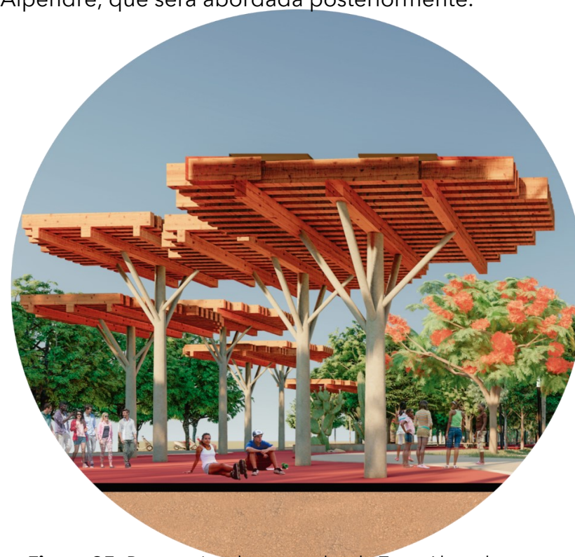
Figura 35: Perspectiva de um trecho da Zona Alpendre parque com foco nos pergolados em concreto e madeira, para gerar sombreamento Fonte: Autor, 2021.
