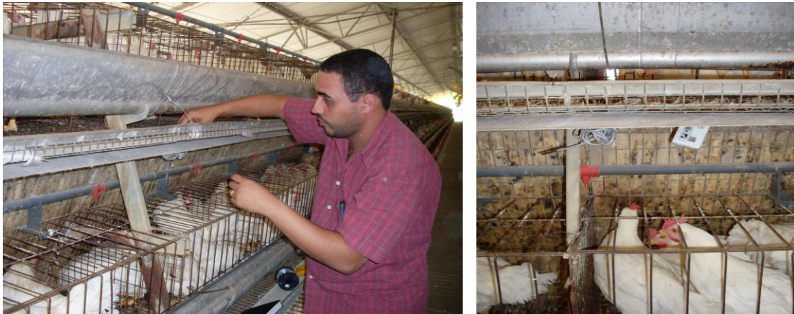
FIGURA 02: Instalação dos equipamentos no galpão, através de mini-estações chamadas de HOBO. União dos Palmares, 07/11/2008.
