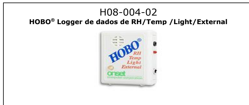
FIGURA 03: Instrumentação utilizada nas amostragens do microclima dentro dos galpões.
