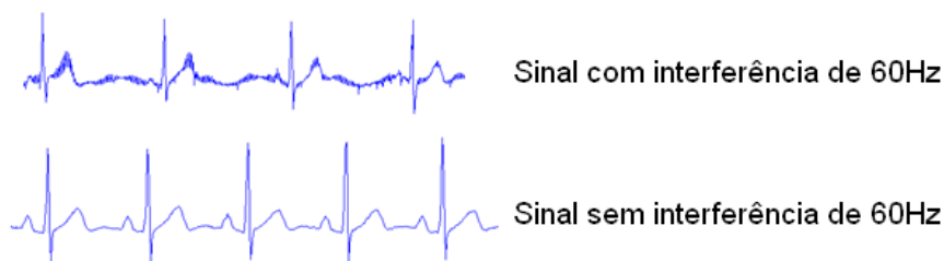
Figura 3.12: Comparação do sinal com e sem interferência de 60Hz
