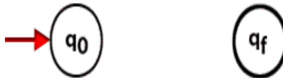
Figura 17: Representação de um estado inicial (esq.) e final (dir.) como nodos de grafos
