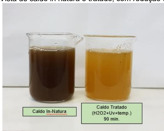
Figura 24 - Vista do caldo in natura e tratado, com redução de 85% da cor
