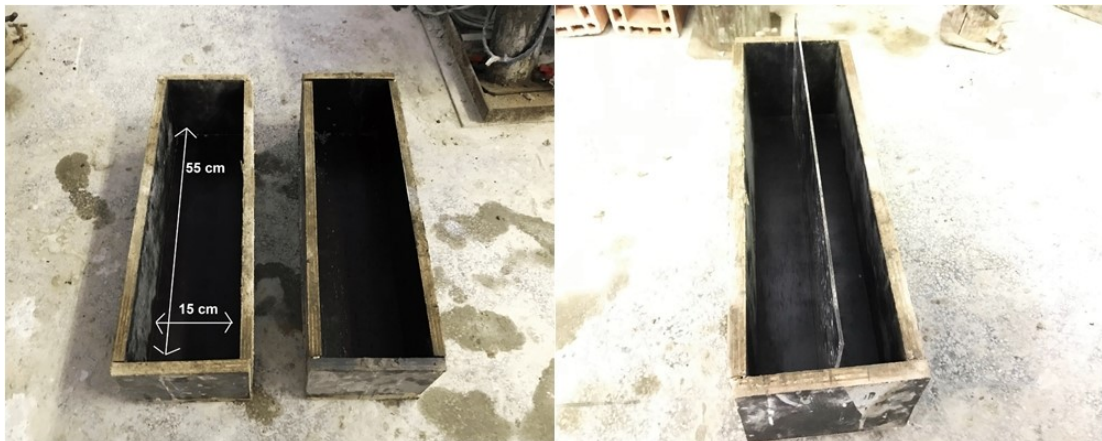
Figura 3.2 – Moldes para moldagem de viga: convencional (à esquerda) e dupla camada (à direita)
