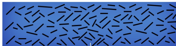
(a) Espécimes desenvolvidos por Oliveira (2019), com distribuição total (100% de CRFA).
