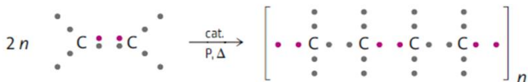
Figura 1 -Reação de Polimerização de Adição.
