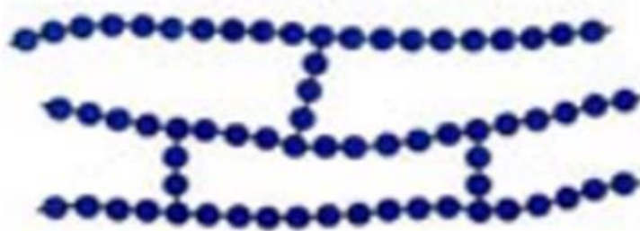
Figura 9 - Representação de um Polímero Termorrígido.
