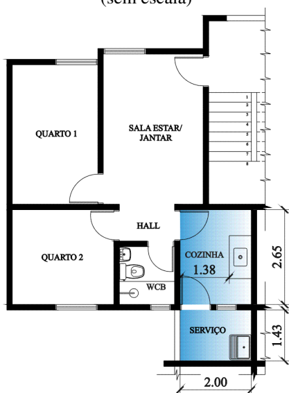
Figura 3.36- Planta Baixa Pav. Tipo: Setor de Serviço dos Residenciais Bariloche, Bosque das Palmeiras e Serraria (sem escala)
