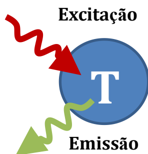
Figura 4.6 – Esquema de simplificado do funcionamento de uma nanopartícula dopada com íons terra-rara.
