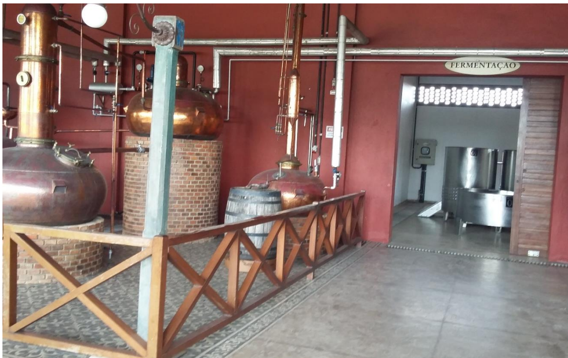
Figura 06. Alambique de Bronze de Destilação da Cachaça. Alambique Caraçuípe.
