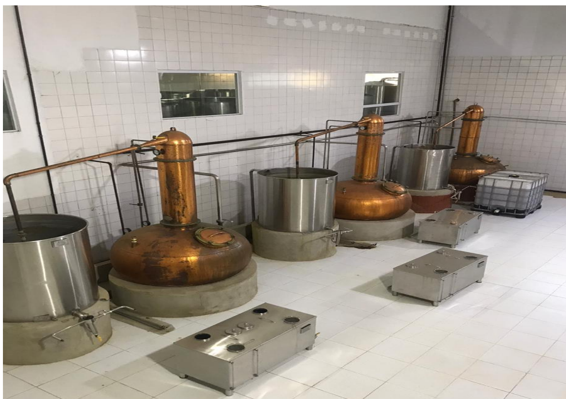
Figura 05. Alambique de Aço Inox e Bronze de Destilação da Cachaça. Alambique Brejo dos Bois.
