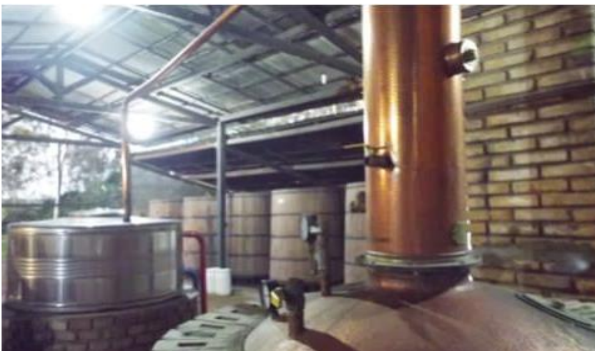
Figura 07. Alambique de Aço Inox e Bronze de Destilação da Cachaça. Alambique Gogó da Ema.
