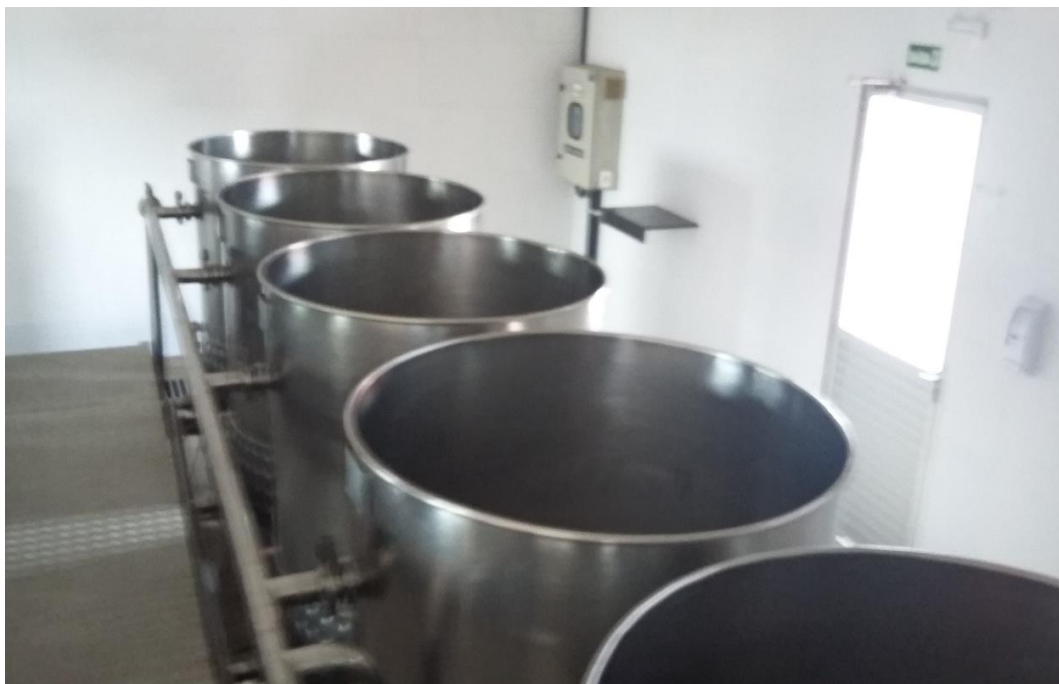
Figura 03. Dornas de Fermentação. Alambique Caraçuípe.
