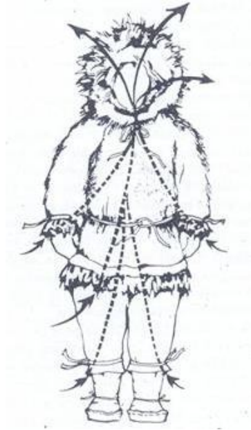
Figura 9: Imagem mostrando a sobreposição de peças. Esquema – ventilação vestimentas inuit
