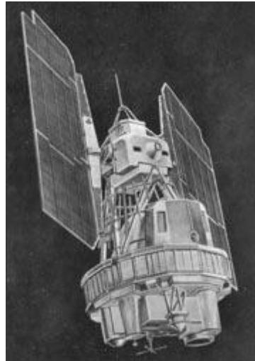
Figura 2. Esquema do satélite ERTS (Landsat 1)
