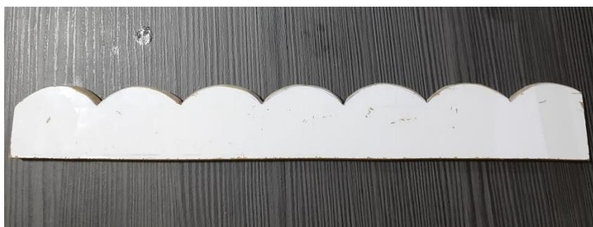
Na figura a cima fizemos a construção a partir da impressão do GeoGebra, colando essa impressão na madeira e realizando o corte com uma maquina de cera, fazendo o acabamento final com lixas de madeiras.
