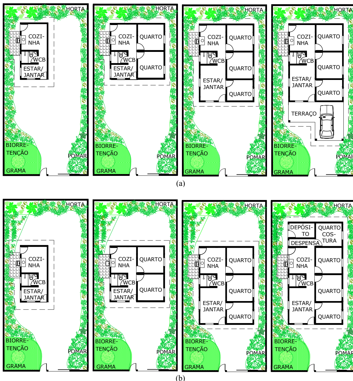
Figura 5.5 – (a) Modelo 01 de ampliação horizontal. Da esquerda para a direita: Casa embrião; Ampliação 1; Ampliação 2; Ampliação 3; (b) Modelo 02 de ampliação horizontal. Da esquerda para a direita: Casa embrião; Ampliação 1; Ampliação 2; Ampliação 3.
