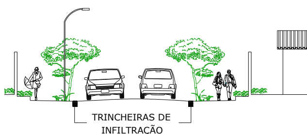
Figura 5.7 – Perfil sugerido das vias locais.
