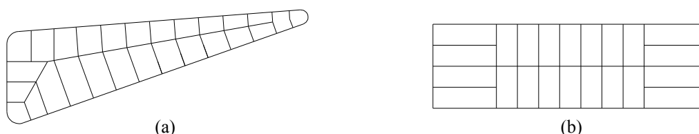
Figura 5.1 – (a) Traçado não-ortogonal; (b) Traçado ortogonal.
