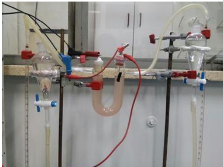
Figura 26- Sistema para a produção do gás hidrogênio via eletrólise.
