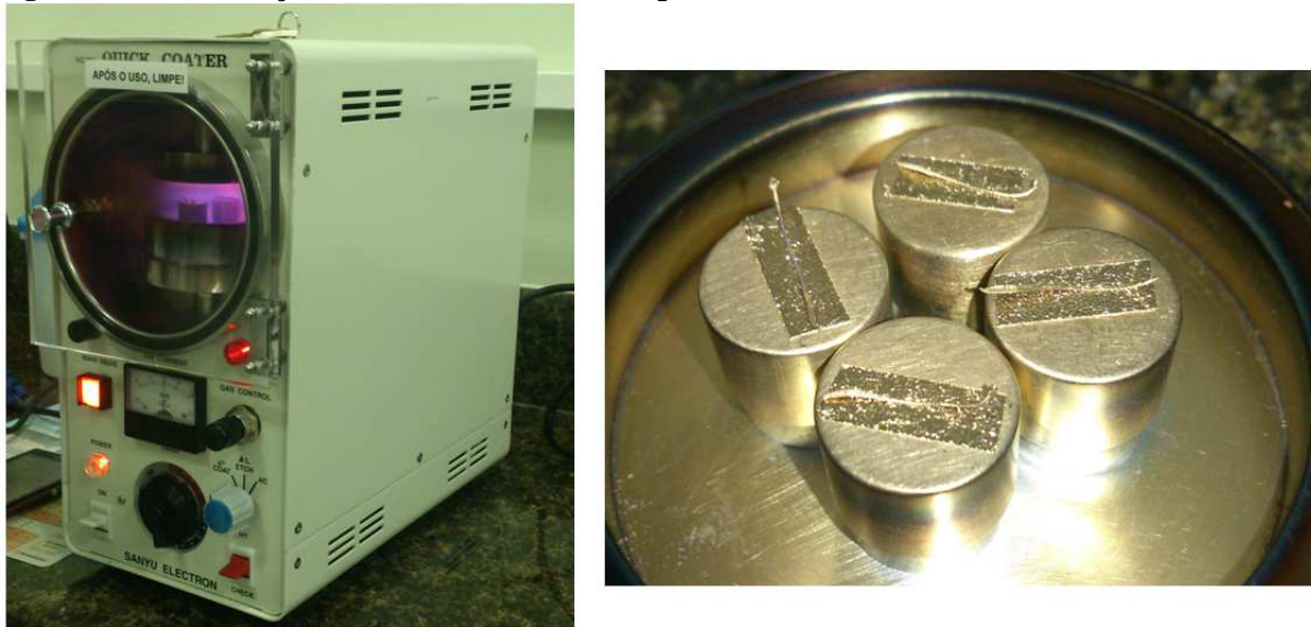
Figura 20 - Metalização de antenas de H. taltula para MEV
