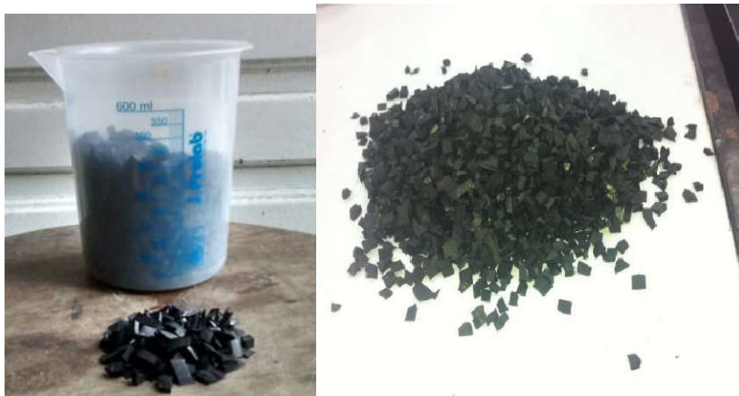
Figura 5 - Pneu triturado que será utilizado como meio suporte do RALF.
