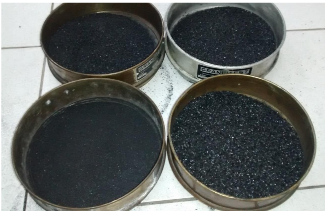
Figura 2. Faixas granulométricas de biocarvão após o processo de peneiramento em laboratório.
