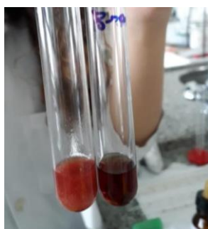
Figura 13 - Reação positiva para taninos totais, com a presença de precipitado esbranquiçado (solução branco à direita).
