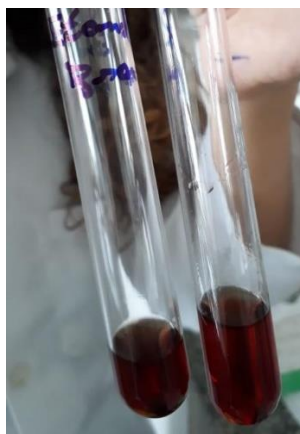
Figura 14 - Reação positiva para taninos condensados (branco à esquerda).
